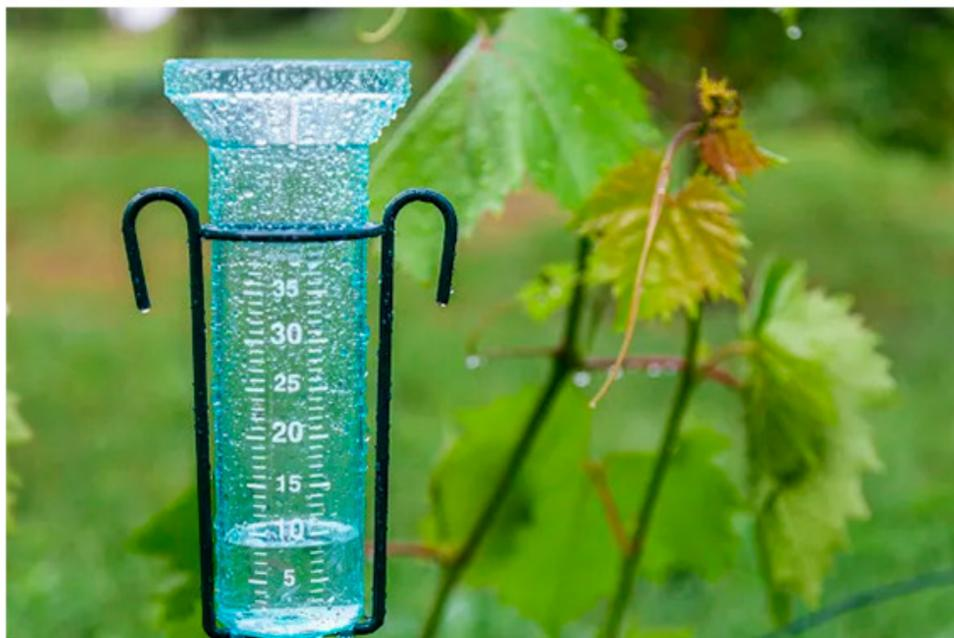
*Pluviômetro simples para a leitura manual do volume de chuvas. Essa medida pode ser observada pela altura da lâmina de água na escala milimétrica.*
